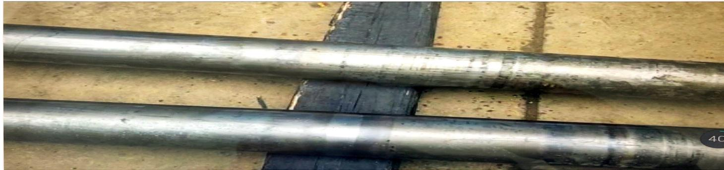
(b) 碳化钨涂层使用 8 天的破磷机辊
